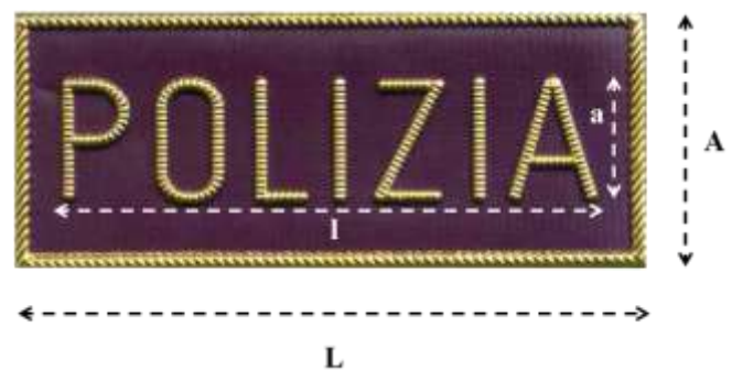
Figura 4: Rappresentazione a titolo puramente esemplificativo e non in scala della targhetta rettangolare con scritta "POLIZIA" con indicazioni di massima sulle dimensioni e sulla foggia. Misure da considerarsi in millimetri con tolleranza di ± 0,2 mm.
